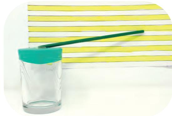
La flecha de un barómetro casero sube o baja dependiendo de la presión atmosférica, relacionada directamente con la temperatura y el clima del día.
