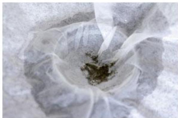
7. Filtren el resto de la mezcla con el colador y recuperen el líquido en un nuevo vaso. Si queda un poco de arena pegada a las canicas y los clavos, lávenlos con agua para que pase por el colador.
