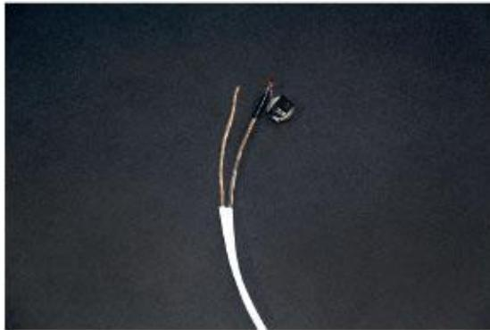
2. Coloquen una terminal del led en una punta del cable y cúbrala con cinta de aislar.
